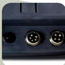
Connecteur d'alimentation, de capteur de chargement et sortie RS232
