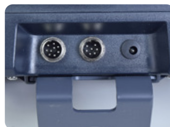
Connexion indicateur plate-forme et alimentation électrique
